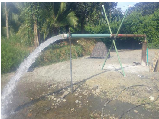
Vista del desarrollo de la prueba de bombeo efectuada por la UTP. Caudal de extracción 29 L/s.
