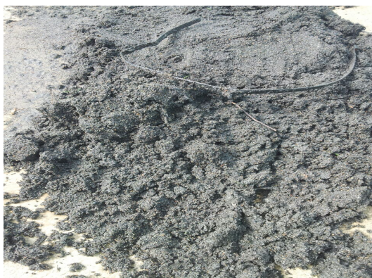
Durante las labores de pistoneo y limpieza se extrae gran cantidad de arenas finas de coloración grisácea. Pistoneo se ejecuta entre el 9 y 10 de abril.
